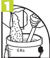
**1** En 6 litros de agua agregue gradualmente un saco (20 kg) de Cemix Basecoat y mezcle hasta obtener una pasta suave y libre de grumos. Espere de 10 a 15 minutos antes de usar la mezcla.
