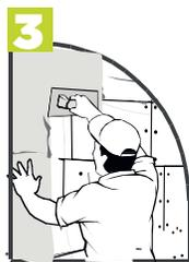
**3** Como recubrimiento de paneles de yeso o fibrocemento y placas de poliestireno, coloque Cemix Basecoat con llana metálica y con movimientos de abajo hacia arriba y de izquierda a derecha formando una cruz
