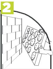
**2** Como adhesivo, coloque Cemix Basecoat sobre la parte trasera de la placa de poliestireno en forma de fajas o montículos y ejerzca suficiente presión para lograr una buena adherencia.
