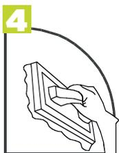
**4** Como recubrimiento, aproximadamente 20 minutos después, con una llana de esponja y con movimientos circulares obtenga el acabado floteado.
