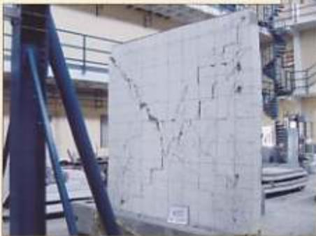
*"El comportamiento de muros reforzados con CASTILLOS ELECTROSOLDADOS DEACERO es cuando menos igual al de los muros reforzados con castillos tradicionales".*
