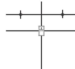
Coloque el mingitorio sobre el soporte e instale la salida de agua en la tubería del desagüe. Coloque los tornillos en las perforaciones para sujeción. Por último, instale el fluxómetro según las instrucciones del fabricante.
