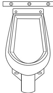
Trace una línea horizontal entre las perforaciones de sujeción, y al centro de esa línea trazar una línea vertical de la medida marcada en el paso anterior. Instale el soporte y realice las perforaciones para la sujeción.
