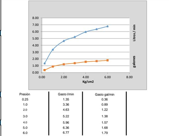
"En caso de instalar el producto a una presión distinta a la indicada alterará el funcionamiento y el consumo de agua del mismo"
