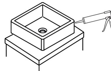
4- Remueva el exceso de pegamento con una estopa. Coloque pegamento nuevamente donde sea necesario. Limpiar el lavabo inmediatamente después de su colocación.
