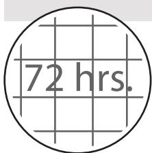
Espere 24 horas para colocar la junta en el caso de pega azulejo normal y 72 horas para un mortero convencional y evitar eflorescencia por exceso de humedad
