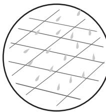
Humedezca la superficie a emboquillar por medio de aspersión, para tener un fraguado controlado, ofrece una mayor resistencia en el color, así como facilitar la limpieza y evitar la creación de manchas. De ninguna manera permita que se estanke el agua en los espacios a emboquillar.
