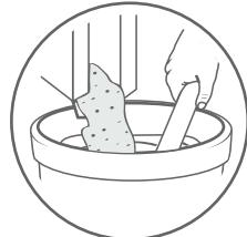
Dosifique el bulto de 10 kg de Pegazim COLOR GROUT hasta lograr una pasta homogénea y trabajable. Deje reposar por 10 minutos y vuelva a mezclar sin agregar más agua.
