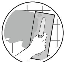
Aplique Pegazim COLOR GROUT con una llana de hule duro, aplicando presión hasta compactar la junta y emparejar con la superficie del piso trabajándola diagonalmente a través de las juntas.
