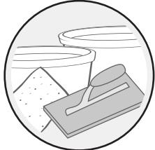
Limpie y elimine excesos de adhesivo en el espacio a emboquillar, uniformizando el ancho y la profundidad mínima de 5 mm. En caso de existir juntas de expansión, respételas.
