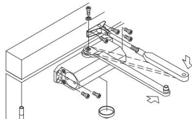
Coloque el brazo y cuerpo del cierrapuertas y sujetélos con respecto a los orificios.
