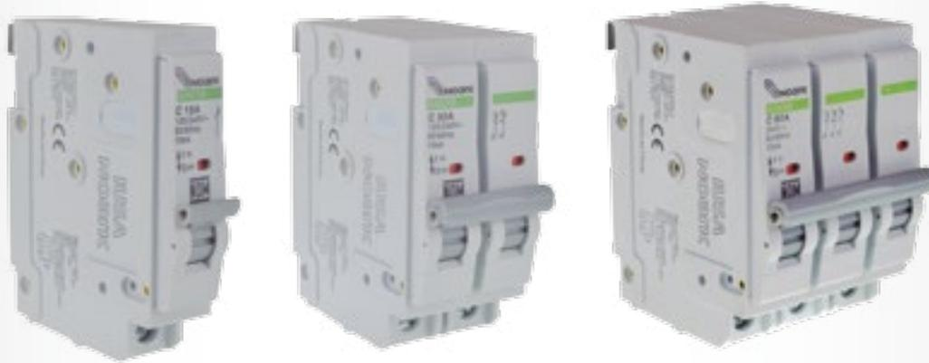
Los **interruptores termomagnéticos** están diseñados para interrumpir la corriente eléctrica de un circuito cuando ésta sobrepasa ciertos valores máximos. El dispositivo consta de dos partes: un electroimán y una lámina bimetálica. Ambas conectadas en serie y por las que circula la corriente que va hacia la carga.
