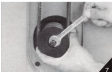
Instale el motor sobre la placa de montaje.
