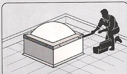
2.- **COLOCAR EL DOMO:** Sobre la base, Una vez colocado el domo, **MARQUE SOBRE LA BASE** las guías que tiene el marco del domo.
