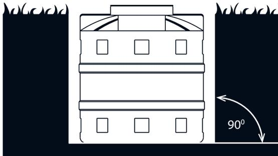
En suelos duros (roca) se recomienda un ángulo de excavación de  $90^{\circ}$
