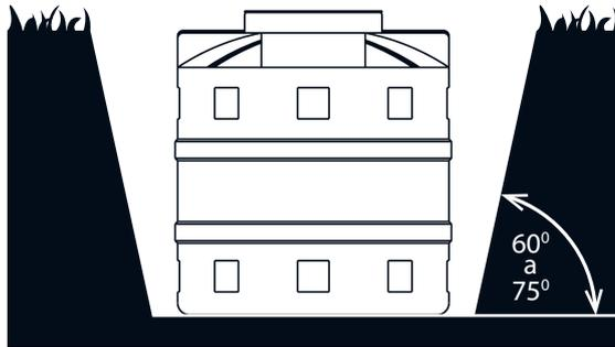
En suelos de resistencia media (tepetate) se recomienda un ángulo de excavación de 60° a 75°
