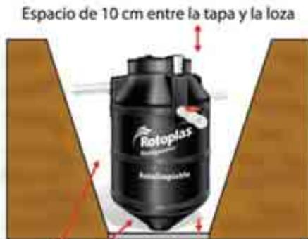
Rellenar con el material de la excavación y apisonar (ver punto 6)
