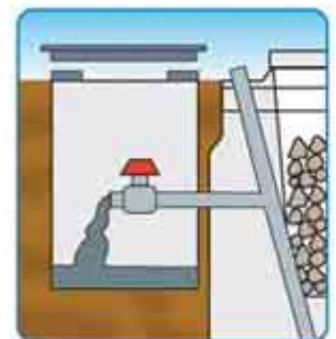
En suelos rocosos puede no ser necesario cavar tanto, por lo que la profundidad de la excavación queda a criterio del instalador.
