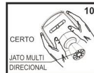
**10** • Instale a Ducha girando-a suavemente sem usar ferramentas (fig.: **10**).
