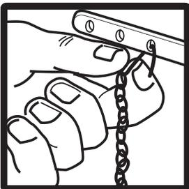
4) Una la cadena al brazo de la palanca del sanitario. Ajuste el largo de la cadena moviendo el gancho sobre la misma, para que quede un poco de juego cuando la pera esté en posición cerrada. Abra el suministro de agua.
