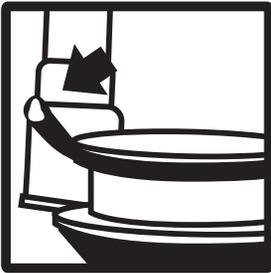
3) Monte la nueva pera, colocando los brazos de hule sobre los soportes laterales de la válvula de descarga, levante manualmente la cadena verificando que la pera gire libremente sobre los soportes sin desprenderse.
