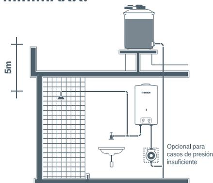
Para su arranque y óptimo funcionamiento, **la altura entre el tinaco y la regadera más alta debe ser mayor a 5m (500 gr/cm<sup>2</sup> de presión de agua)**. Si no cuenta con la presión de agua necesaria, se recomienda adquirir una bomba presurizadora que le garantizará una excelente operación, máximo confort y agua caliente sin límites.
