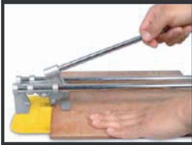
Raye de una sola vez por el lado esmaltado desde el extremo próximo al operario, con la cuchilla de corte con movimiento hacia adelante y haciendo presión con la manivela.
