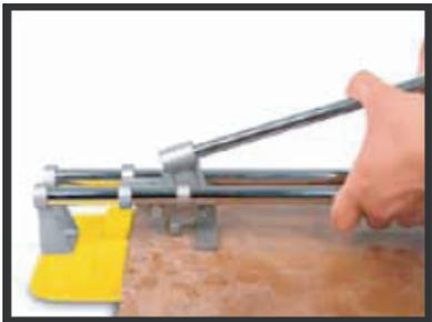
Posicione el quebrador al final del azulejo, presionando ligeramente sobre la palanca.
