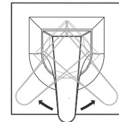
Para regular la temperatura del agua, gire la palanca hacia la izquierda (agua caliente) y hacia la derecha (agua fría)
