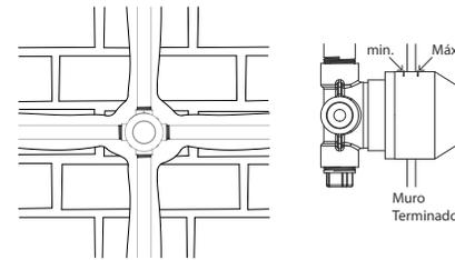
Realice en el muro una cavidad de acuerdo a la longitud y profundidad del Cuerpo (5) y de las tuberías de alimentación y salida a regadera y/o tina.
