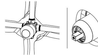
Una vez que haya instalado las tuberías, abra la alimentación de agua para verificar que no existen fugas.
