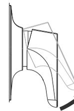
Para abrir el flujo de agua, jale la palanca hacia arriba. Para cerrar el flujo empuje la palanca hacia abajo.
