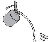
Después de mucho uso, deberá cambiar el aceite para asegurar una larga vida para su equipo. Para drenar el aceite, abra la válvula de liberación. Asegúrese de que no entre basura en el sistema. Llene únicamente con aceite apto para gatos hidráulicos, como se indica en el párrafo 2.
