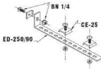
EL CONECTOR ED-250/90 SE COLOCARA DE ESTA MANERA PARA FORMAR UNA TEE O EQUIS HORIZONTAL SOLO CUANDO SE INSERTE UNA CHAROLA TIPO MALLA CON ANCHO 60, 150 Y 400
