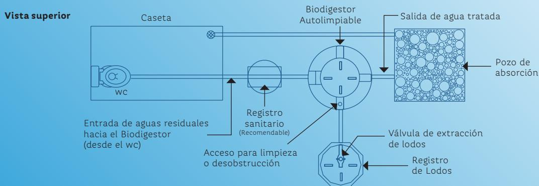
Nota: no reutilices el agua tratada, deberá ser descargada a suelo (pozo de absorción o zanja de infiltración), utilizando las recomendaciones indicadas por la NOM-006-CONAGUA-1997.
