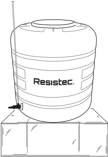
Fig.2. Detalle de Tinaco instalado.
