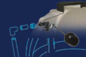
4 Remueve el tapón hexagonal de la conexión de salida de agua ubicada en la parte lateral inferior del Tanque
