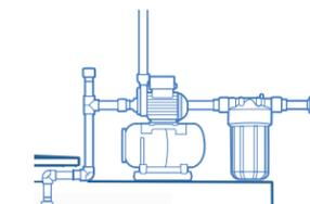
7 Instala el Filtro de sedimentos Jumbo seguido del medidor o de la bomba de agua
