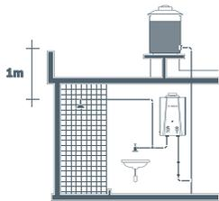
Para su arranque y óptimo funcionamiento, la altura entre el tinaco y la regadera más alta debe ser mayor a 1m (100gr/cm2) de presión de agua.
