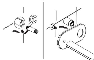
2- Una vez realizada la conexión a la red hidráulica, realice el terminado del muro, retire los protectores. Coloque cinta selladora (no incluida) en el conector (13) y rosquelo al cuerpo. Tome el ensamble de la cubierta (9) y la nariz (17) y asegúrese que el O-ring (14) este correctamente colocado, enseguida introdúzcala en el casquillo (8) del monomando hasta topar con la pared.
