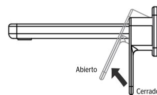
1- Para abrir el flujo del agua, jale la palanca del maneral (2) hacia abajo. Para cerrar el flujo empuje la palanca del maneral hacia arriba.
