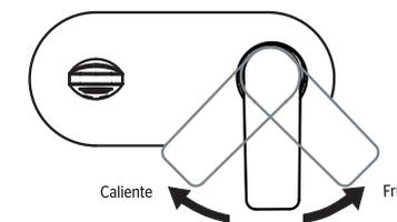
2- Para regular la temperatura del agua, gire la palanca del maneral (2) hacia la izquierda (agua caliente) y hacia la derecha (agua fría).
